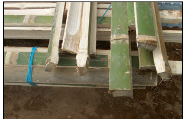
Fig. 2: latas frescas, cortadas con disco paralelo
