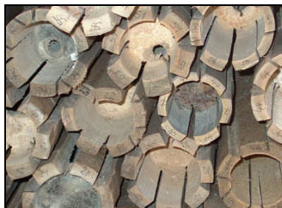
Fig. 6: cantidades y tamaños de latas posibles de un tubo de guadua
